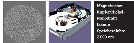
Nanodrähte finden in den Leseköpfen von Computerfestplatten Verwendung. Sie ermöglichen eine höhere Speicherdichte und dadurch mehr Speicherplatz. © Alan Brown
