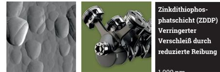
Beschichtungen und Schmierstoffzusätze reduzieren die Reibung und den Verschleiß von Motorteilen. Eine Zinkdithiophosphat Tribolayer (ZDDP) bildet eine weiche, verformbare Schicht auf den beweglichen Oberflächen des Automotors (z. B. Kolben oder Nockenwellen), so dass die Teile leichter übereinander gleiten und sich der Verschleiß verringert.
