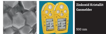
Derzeit können fotoelektrische Rauchmelder größere Rauchpartikel in dichtem Rauch erkennen, nicht aber die kleinen Partikel im Rauch von schnell brennendem Feuer. Gassensoren wandeln die Gaskonzentration in ein elektronisches Signal um. Zinkoxid ist ein Halbleitermaterial mit der Fähigkeit, Gas aufzuspielen. Wenn es als Nanokristall aufbereitet wird, ermöglicht es eine viel größere Erfassungsfläche und ist viel empfindlicher gegenüber Gasmolekülen. © Matthew Murray
