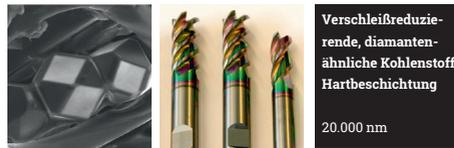
Diamantenähnlicher Kohlenstoff dient im technischen Bereich der Ingenieurwissenschaften als Hartbeschichtung auf Metallbauteilen zur Verschleißreduzierung. Verschiedene Formen können kombiniert werden, um einer Beschichtung spezielle Eigenschaften zu verleihen.
