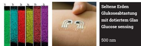
Erbium ist eine Seltene Erde mit besonderen lichtabsorbierenden Eigenschaften. Wenn es Lichtstrahlen spezieller Wellenlängen absorbiert, strahlt es Licht in bestimmten Wellenlängen wieder ab. Diese Wellenlänge kann so präzise kontrolliert werden, dass Glukosemoleküle sogar durch Haut und Venen hindurch aufgespürt werden können. Dadurch wird Diabetes-Patienten eine nichtinvasive Glukosemessung ermöglicht. © Jayakrishnan Chandrappan, Jacobs School of Engineering/UC San Diego
