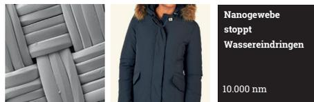
Nanogewebe verhindert das Eindringen von Wasser in den Stoff ohne Minderung der Stoffqualität. Mit Nanomaterialien lassen sich Stoffeigenschaften verbessern, ohne dass die Gewebe dadurch steifer, schwerer oder dichter werden. Das Material lässt sich je nach den verwendeten Nanomaterialien auch stärker wasser- oder schmutzabweisend oder antimikrobiell gestalten.
