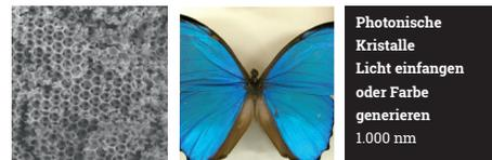
Die reguläre poröse Struktur photonischer Kristalle kann verwendet werden um Licht einzufangen oder zur Farbgebung (wie beim Schmetterlingsflügel). Die reguläre Lochstruktur fungiert als Beugungsgitter - bestimmte Wellenlängen des Lichts werden eingefangen und absorbiert - das verbleibende Licht ergibt exakte Farben.
